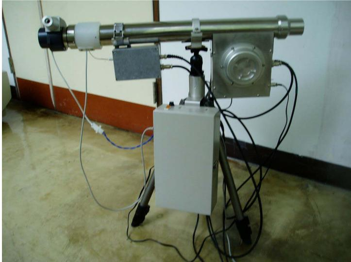
第1図 独自開発の大気イオン濃度測定器
